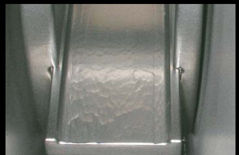
IWM Wurfschaufel nach 8.000 Betriebsstunden
